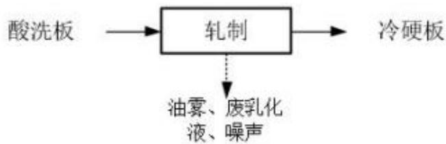
图 3.4.1-2 冷硬板工艺流程图
